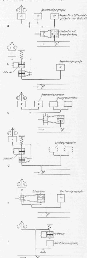
Bild 4. Trotz aller Vielfalt von Regelelementen für die Drehzahl und deren 1. und 2. Differentialquotienten, von Katarakt, Integrator, Druckstossdetektor, Rückführverzögerung, integrierendem und rein verstärtendem Stellmotor streben alle Kombinationen den gleichen Effekt ant dem heutigen proportional-integral wirkenden PI-Regler eine differentiale D-Wirkung hinzuzufügen, um die Reglung dadurch zu verbessern.
