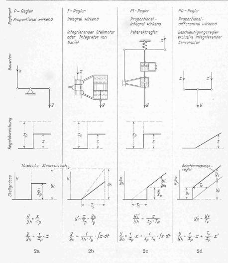
Bild 2. Uebergangsfunktionen von P-, I- und PD-Regelelementen zeigen die Aenderung der Stellgrösse y am Ausgang des Regelelements bei Aenderung der Regelgrösse x am Eingang
