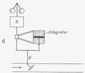
Bild 3. Alle heute verwendeten Regler für Wasserturbinen sind PI-Regler. Der Beschleunigungsregler hat identischen Regelverlauf wie die übrigen Bauarten, also auch gleiche Stabilität und Frequenzhaltung, weil seine Differentialwirkung durch die Intregalwirkung des nachfolgenden integrierenden Stellmotors (Servomotor) wieder aufgehoben wird.
