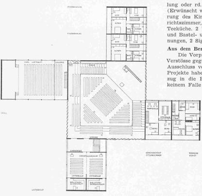
Obergeschossgrundriss. Alle Grundrisse, Schnitte und Fassaden im Masstab 1:600
