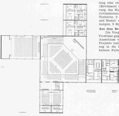
Obergeschossgrundriss. Alle Grundrisse, Schnitte und Fassaden im Masstab $1\colon\! 600$
