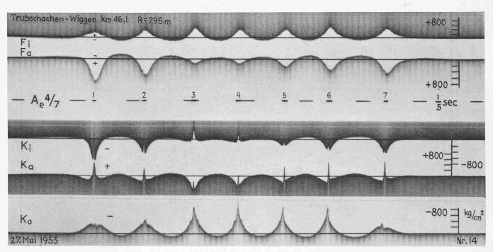
Bild 3. Schienenspannungen an den in Bild 1 bezeichneten Stellen unter der mit 45 km/h fahrenden Lokomotive Ae 4/7. Photographie eines Oszilogramms
