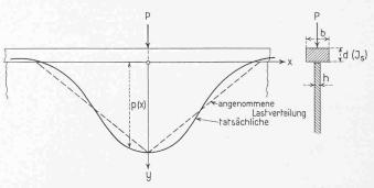
Bild 4. Darstellung der Annahmen für die Näherungsberechnung der sekundären Biegung des Schienenkopfes
