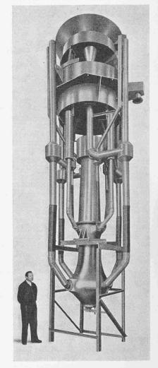
Bild 3. Vertikale Schlämmapparatur zur Trennung des Sandes  $0\div 3$  mm bei 1 mm. Leistung : 35 t Sand/h
