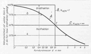
Bild 4. Graphische Erläuterung der Methode zur Charakterisierung der Trennschärfe von Sandtrennungsanlagen
