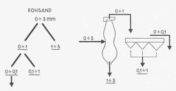
Bild 2. Schema der Sandtrennung
