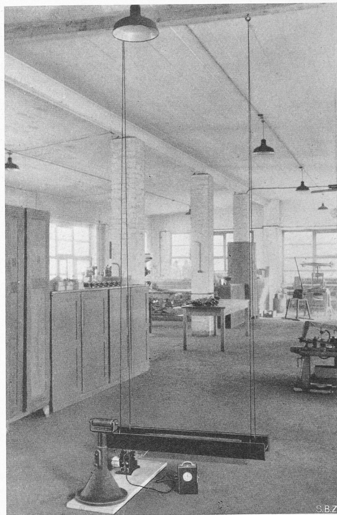
Bild 12. Einrichtung zum Messen von Waagrechtsschwingungen
