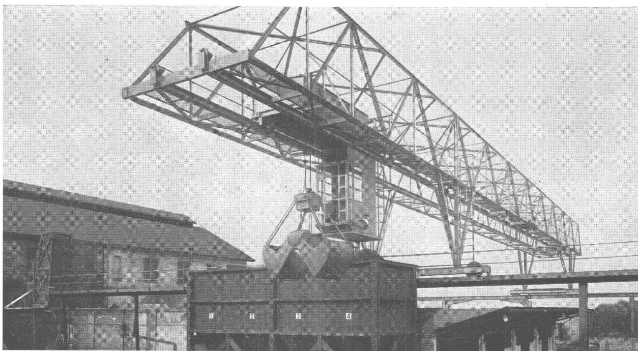
Verladebrücke in Schweisskonstruktion 2,5 t Tragkraft, 46 m Länge
