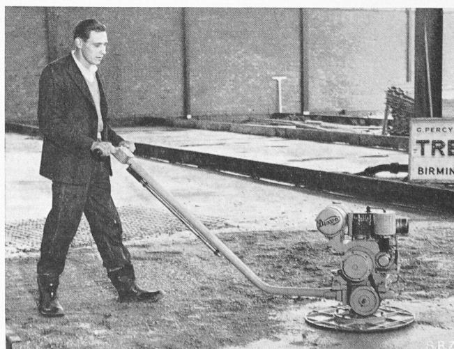
zu  $\frac{1}{4}$ " = 6,7 mm Dicke) aufgebracht werden, wodurch sich beträchtliche Materialersparnisse erzielen lassen. Die Fertigungsgeräte werden entweder mit elektrischem Antrieb (1½ PS Einphasenmotor für 50 Hz und die üblichen Spannungen) oder mit Benzinmotor (3½ PS mit Brennstoffvorrat für 8 Stunden) geliefert.
