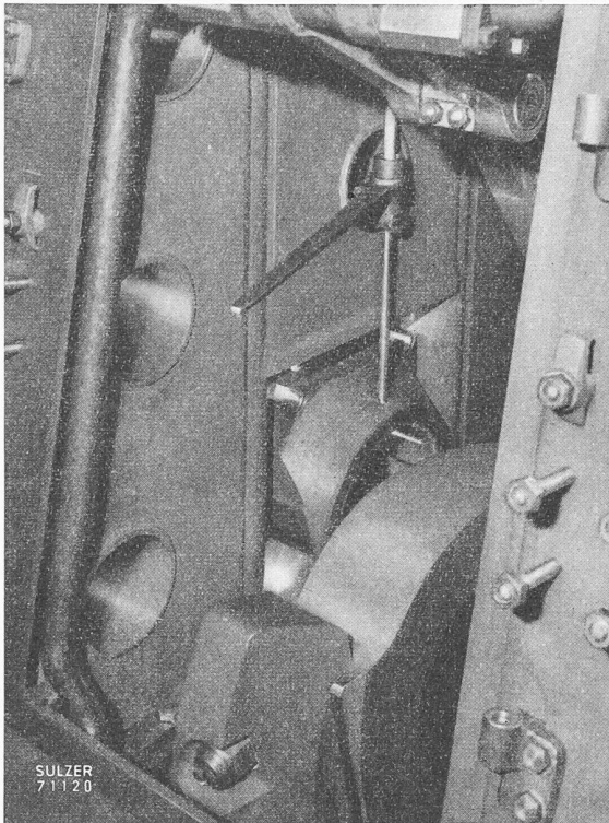
Bild 29. Die Deckel der Kurbelwellenlager können zu Inspektionszwecken mit Hilfe von Gewindestangen emporgehoben und sodann entfernt werden, worauf sich auch die unteren Lagerschalen in üblicher Weise herausnehmen lassen
