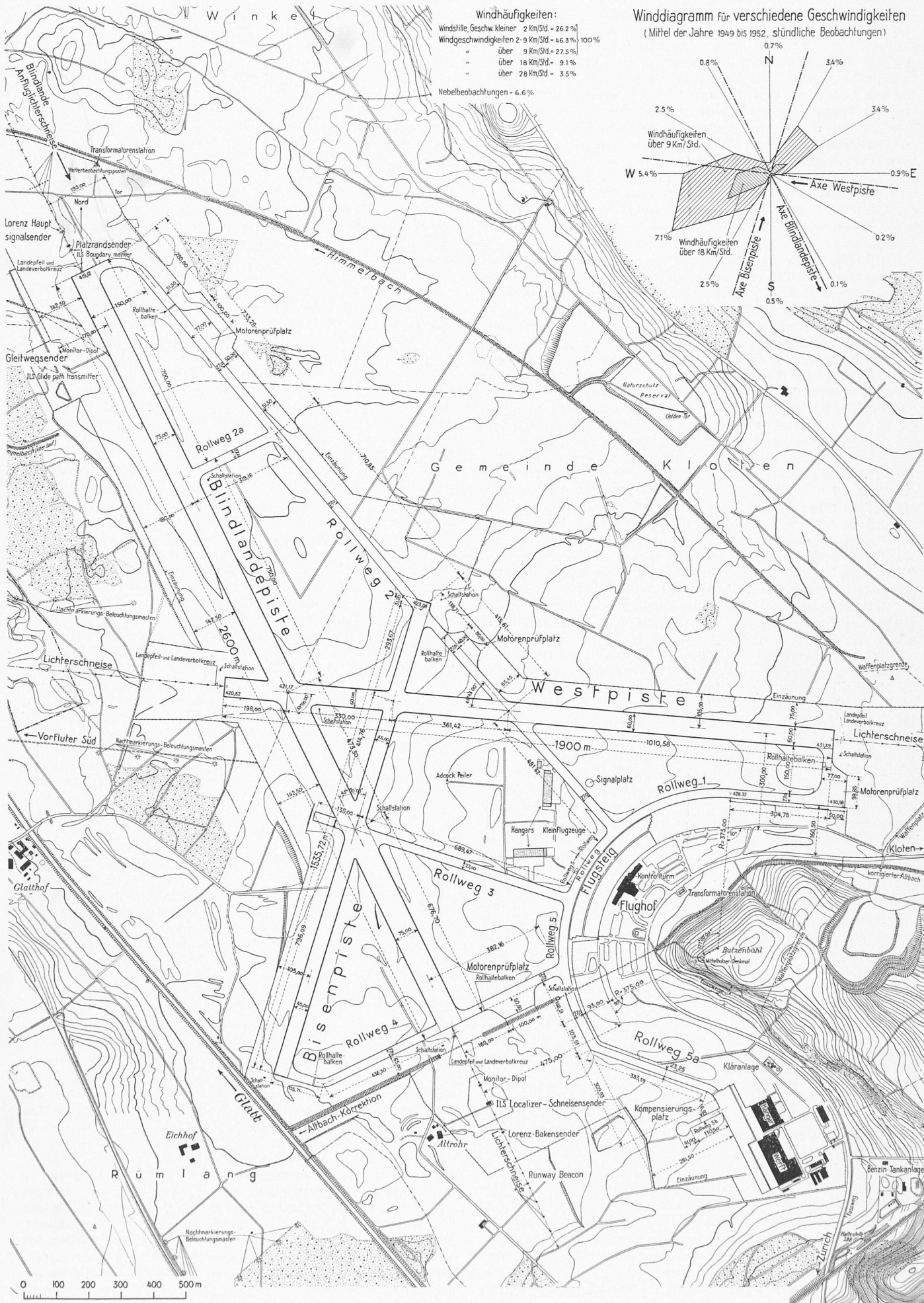
Bild 5. Flughafen Zürich-Kloten, Gesamtausführungsplan mit Winddiagramm, Masstab 1:15 000
