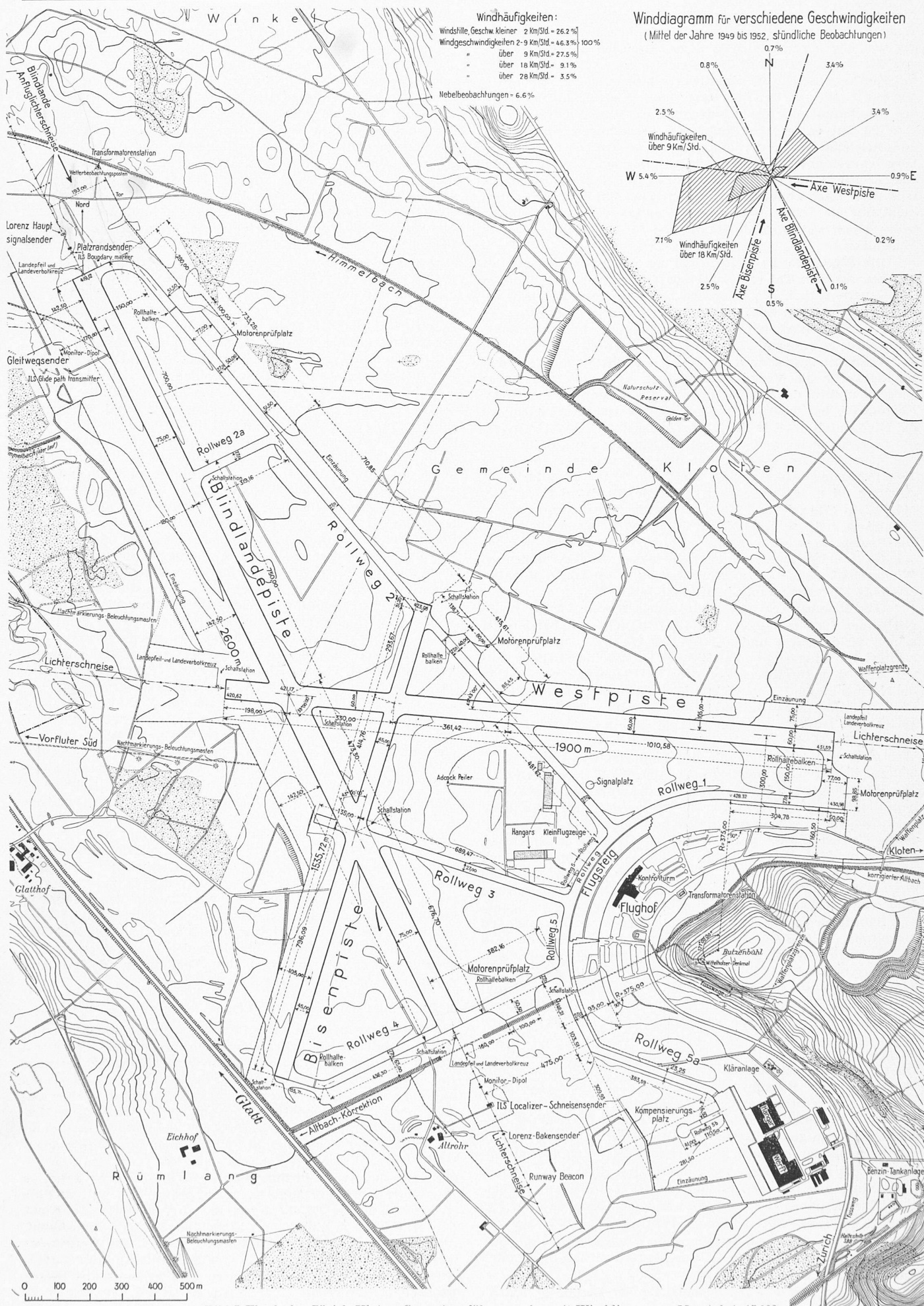
Bild 5. Flughafen Zürich-Kloten, Gesamtausführungsplan mit Winddiagramm, Masstab 1:15 000
