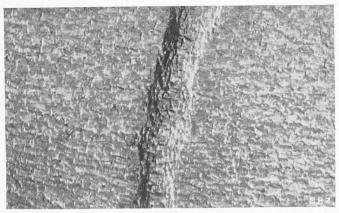
Bild 6. Eine maschinell entrostete Fläche, abgebildet im linearen Masstab 2,25:1. Auch die Schweissraupe ist lupenrein entrostet; die im Bilde dunkeln Stellen sind Schatten
