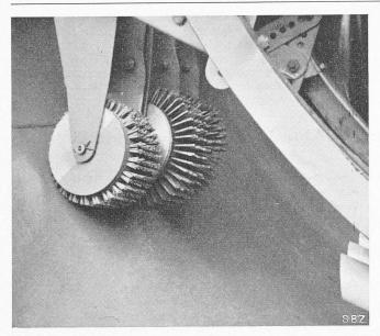
Bild 2. Stachelscheiben der Rohrreinigungsmaschine nach Bild 1, mit meisselförmigen Stachelenden
