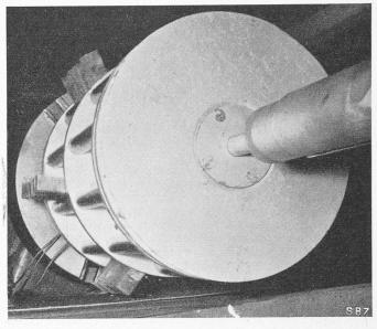
Bild 3. Ein von Arx-Entrostungsrad mit schwenkbaren Stahlblechlamellen, das auch Rostgruben sauber entrostete, bei Versuchen auf einer Drehbank; Drehzahl etwa 600 U/min. Elektronenblitzaufnahme
