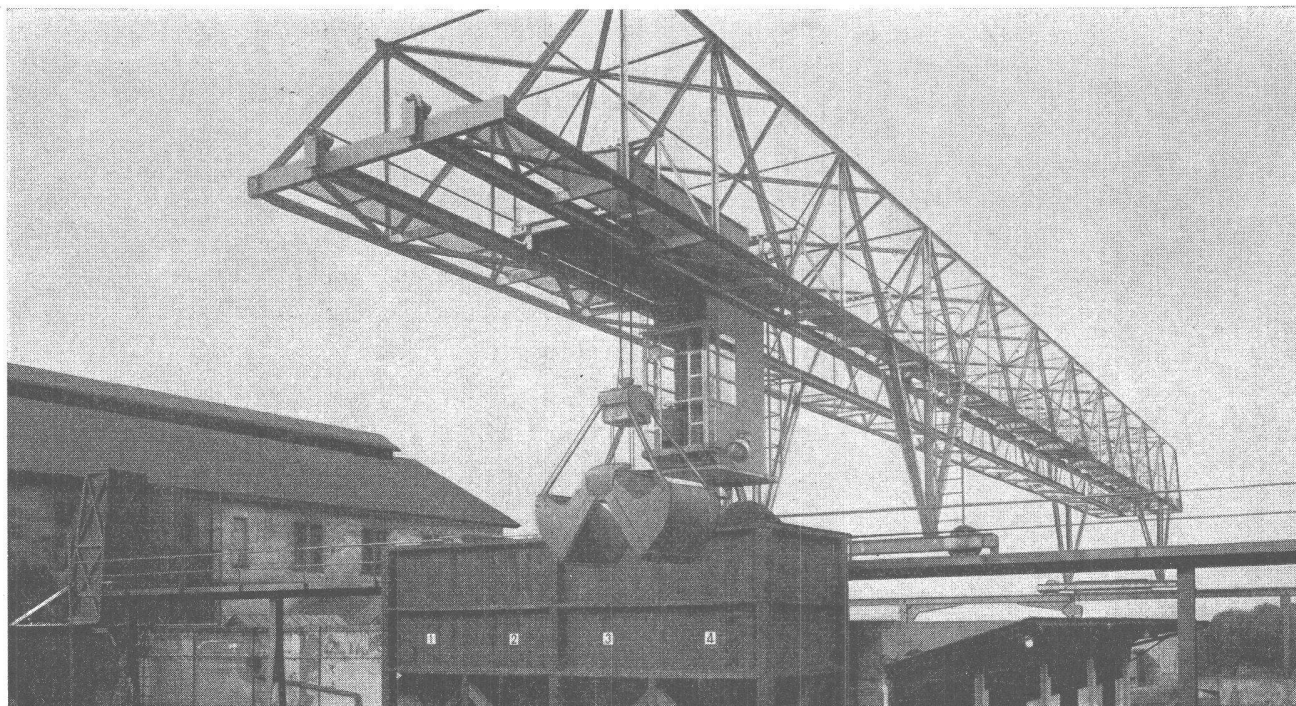
Verladebrücke in Schweisskonstruktion 2,5 t Tragkraft, 46 m Länge
