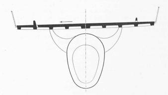
Bild 35. Querschnitt 1:120. Vorschlag von Ing. H. HILFIKER: Brücke mit torsionssteifem Rohrträger aus Chromnickelstahl und Fahrbahn aus vorfabrizierten Spannbetontafeln
