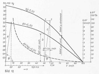
höhen kann, ohne dass es zu einem Ueberschreiten der Grenzgleitgeschwindigkeit kommt. Mit zunehmender Fahrgeschwindigkeit sinkt allerdings die mögliche Ueberdrehzahl stark ab, doch ist in diesem Gebiet wegen der abnehmenden Zugkraft die Schleudergefahr auch nicht mehr gross.
