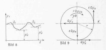
ausserdem kleiner als das Moment des Reibungswiderstandes an der Schiene, also auch  $\mu_{sa} < \mu'_s$  sei. Der Unterschied der Reibungswerte ist  $\varDelta \mu_s = \mu'_s - \mu_{sa}$ . Man erhält aus Gleichung (6) den Ausdruck  $r \, Q \, (\varDelta \, \mu_s \, + \, \epsilon \, \mu_K) \, - \, \gamma \, \Theta = 0$  und weiter
