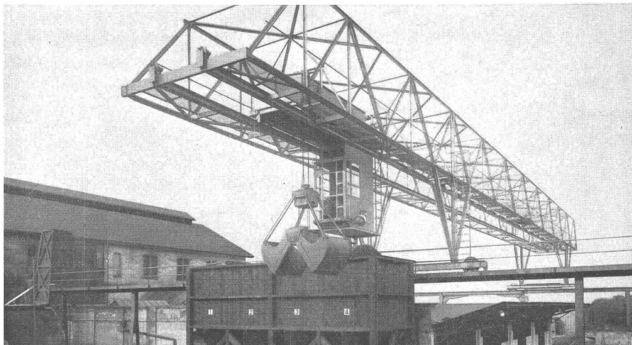
Verladebrücke in Schweisskonstruktion 2,5 t Tragkraft, 46 m Länge
