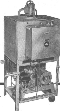
**Therma** baut diese transportablen Luftentfeuchter mit freier Raumluftzirkulation sowie ortsfeste Apparate für den Anschluss an Luftkanäle.
