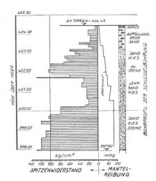
Diagramm einer Rammsondierung
