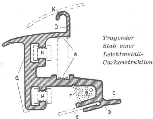
A = Verdeckführung, B = Kabelrinne, C = Auflage für Doppeldach, D = polierter Zierstab, E = Innenverschaltung, F = Klemmbride, G = Anschlussfläche der Gehrige-Konstruktion, H = Verdeckkettenführung, J = Spritzwasserfang, K = Verdeckauflage und Tropfnase
