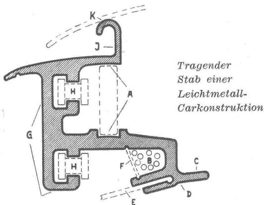
A = Verdeckführung, B = Kabelrinne, C = Auflage für Doppeldach, D = polierter Zierstab, E = Innenverschaltung, F = Klemmbride, G = Anschlussfläche der Ge-rippekonstruktion, H = Verdeckkettenführung, J = Spritzwasserfang, K = Verdeckauflage und Tropfnase
