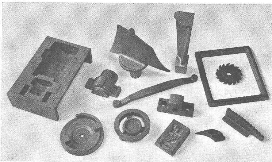
Bild 3. Einige nach dem zweiseitigen Formverfahren in der Sulzer-Präzisionsgiesserei hergestellte Guss-Stücke
