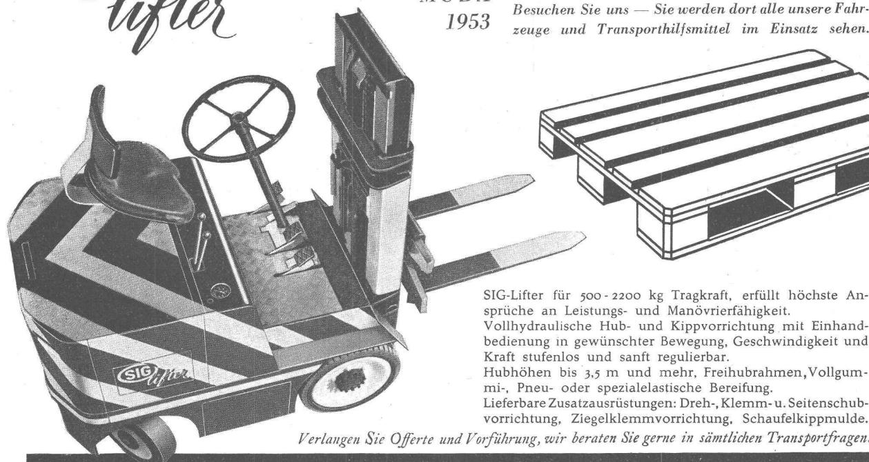
SIG-Lifter für 500-2200 kg Tragkraft, erfüllt höchste Ansprüche an Leistungs- und Manövrierfähigkeit. Vollhydraulische Hub- und Kippvorrichtung mit Einhandbedienung in gewünschter Bewegung, Geschwindigkeit und Kraft stufenlos und sanft regulierbar. Hubhöhen bis 3,5 m und mehr, Freihubrahmen, Vollgummim-, Pneu- oder speziellelastische Bereifung. Lieferbare Zusatzausrüstungen: Dreh-, Klemm- u. Seitenschubvorrichtung, Ziegelklemmvorrichtung, Schaufelkippmulde.
