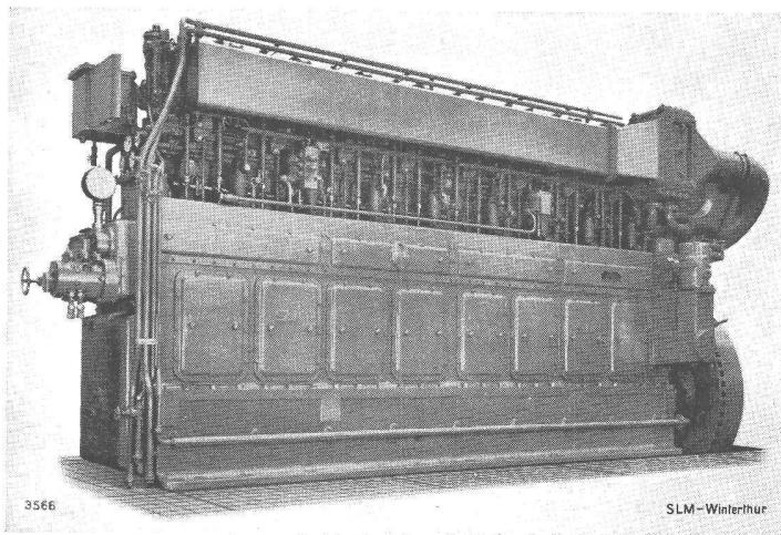
SLM-Schiffsdieselmotor, Nennleistung 1200 PS bei 475 U/min
