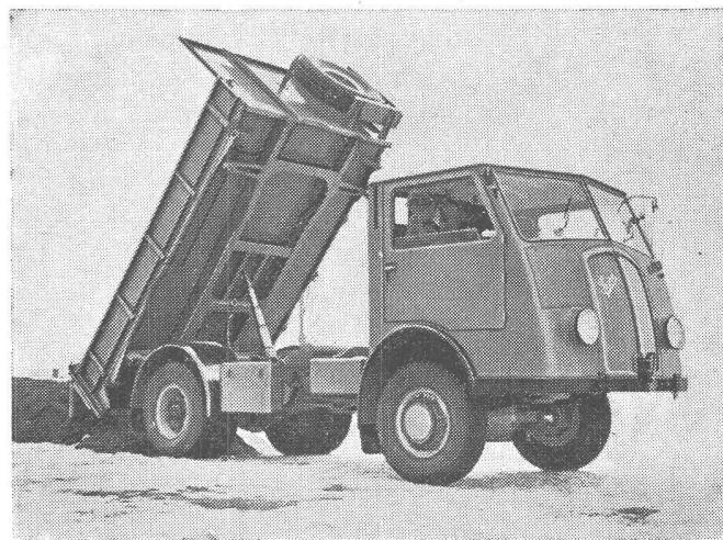
Schwerer Dreiseitenkipper 5 CM, 4 m<sup>3</sup>, mit Allradantrieb
