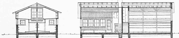
Querschnitt durch den Schlafteil (Prinzip von Boldern)
