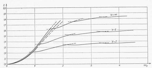
Graphische Zusammenfassung der numerischen Auswertung der Abhängigkeit des Knicklastenverhältnisses k von der Verwindung  $\omega_0$  eines einseitig eingespannten Stabes.
