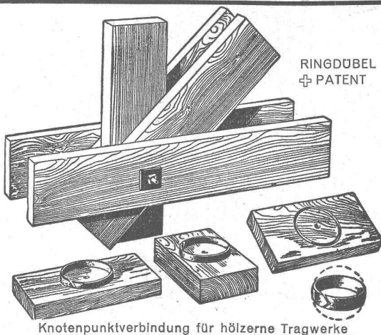
Knotenpunktverbindung für hölzerne Tragwerke
