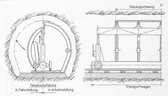
Bild 6. Fahrbare Montagevorrichtung für betätigte Teleskopschalungen
