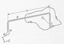
Bild 1. Schema des Planimeters
