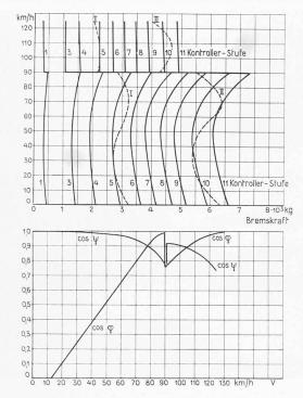
Bild 15. Bremscharakteristiken der A<br/>e $6/6\text{-}\mathrm{Lokomotive}$  V Geschwindigkeit in km/h
