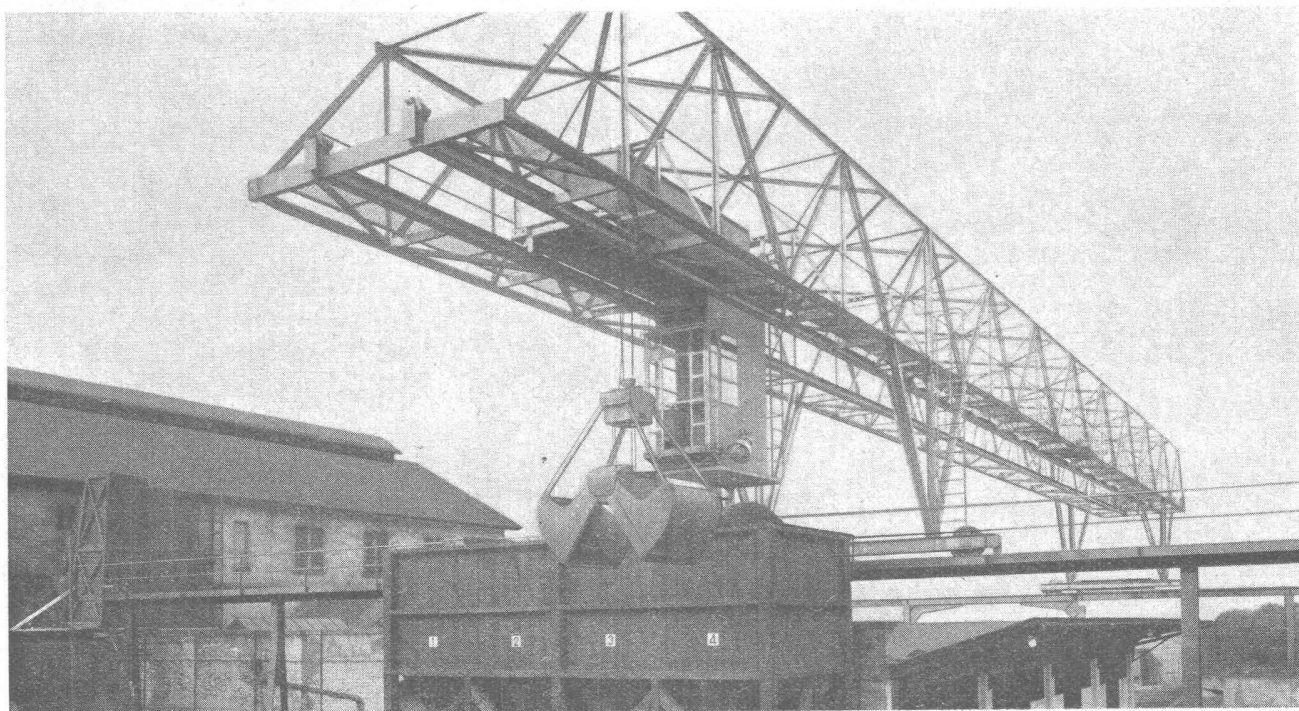
Verladebrücke in Schweisskonstruktion 2,5 t Tragkraft, 46 m Länge
