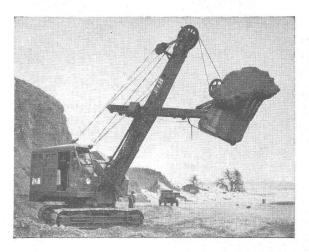
Löffelbagger mit Tru-Lay-Brugg-Drahtseilen ausgerüstet
