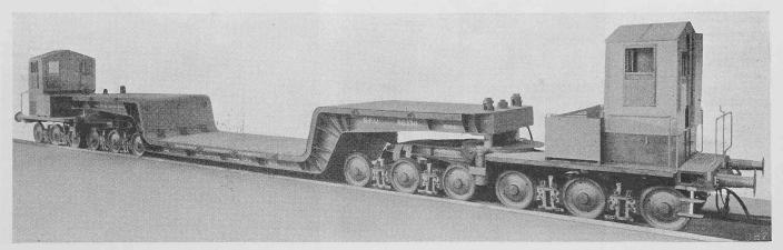
Bild 5. Tiefladewagen SWS Schlieren für 132 t Ladegewicht, indische Breitspur
