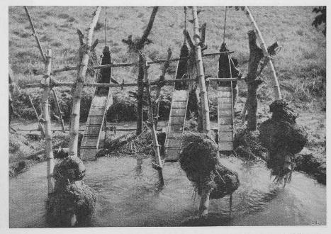
Bild 12 «Droni» (Schöpfbäume) aus Blech, mit Handbetrieb, am Grand Trunk Road bei Burwan
