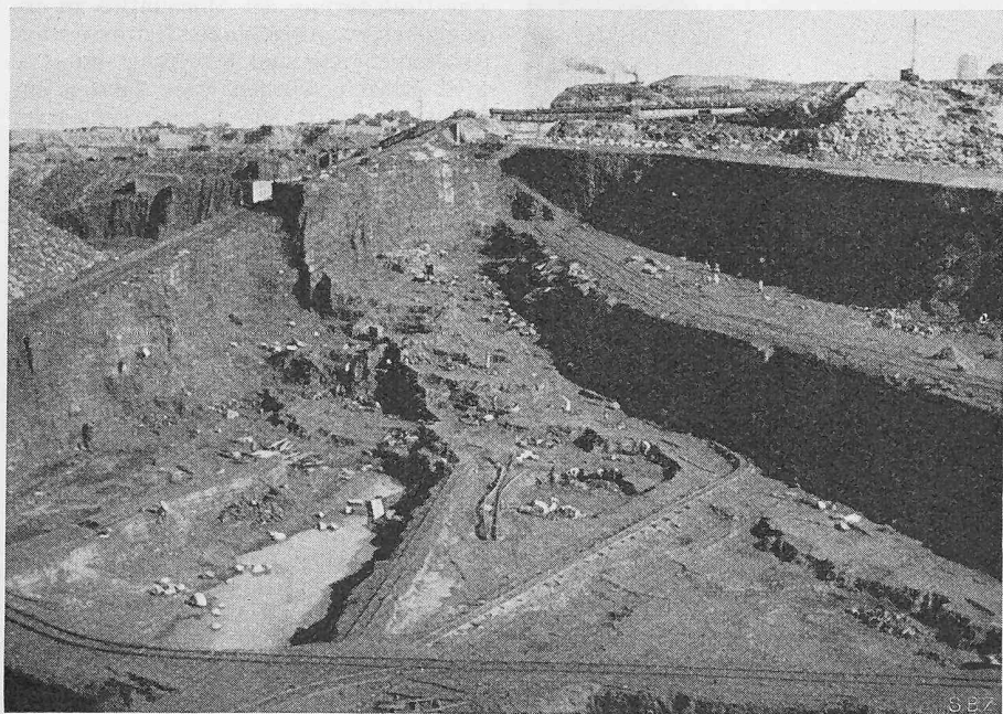
Bild 19. Abbau eines 50 m mächtigen Kohlenflözes im Tagbau in einer Mine von Bokaro im Damodartal in Bihar
