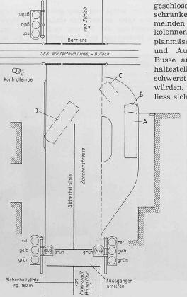
Bild 1 (links), Situationsschema der Lichtsignal-Anlage beim Niveauübergang der Hauptstrasse Winterthur - Zürich über die SBB-Linie Winterthur - Bülach
