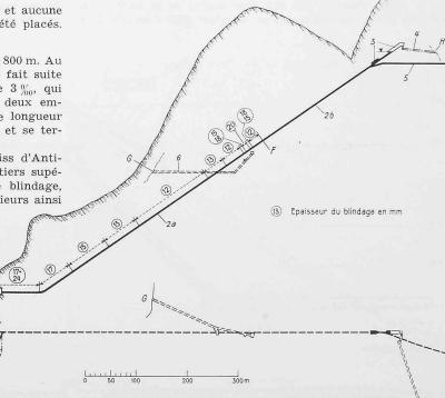
Fig. 1. Schéma du puits incliné de la Centrale de Gondo, plan et profil en long Légende: 1 Centrale de Gondo, — 2a Partie blindée du puits, du point F & la centrale. — 2b Partie non blindée du puits, en amont du point F. — 3 Chambre d'équilibre. — 4 Fenêtre d'accès à la chambre d'équilibre. — 5 Galerie d'amenée d'eau, — 6 Fenêtre de drainage servant d'accès au puits pendant les travaux. — F Limite supérieure du blindage du puits. — G Débouché de la fenêtre Nº 6. — H Débouché
