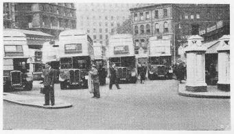
Bild 1. Ausgangsstation für acht Sladtlinien vor dem Victoria-Bahnhof, mit schärfster Ausnützung des vorhandenen Platzes (Bahnsteige knapp 1 m, Fahrbahnen 2,7 m breit)
