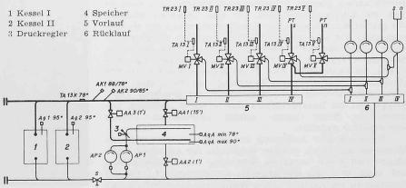
Bild 2. Prinzipielles Leitungsschema der Heizanlage
