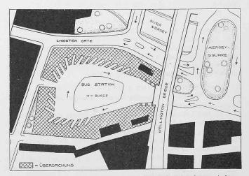
Bild 5. Projekt für den künftigen Omnibusbahnhof Stockport. Anlegestellen der Autobusse in Buchtform am inneren Rande eines ringförmigen Gemeinschaftsbahnsteigs. (Die ankommenden Busse fahren vorwärts in die Buchten ein, um nach dem Passagierwechsel rückwärts in die Kreisfahrbahn auszufahren und dort zu wenden.)
