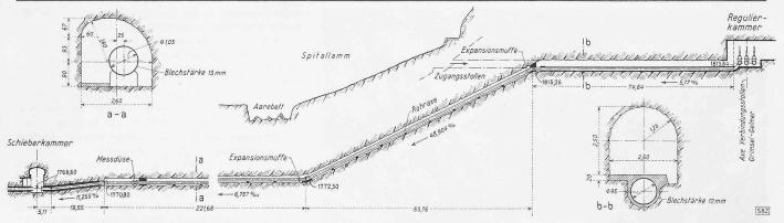
Bild 59. Pumpenzuleitung von der Grimselsee-Regulierkammer zur Zentrale Grimsel; Längsprofil 1:1500, Schnitte 1:150.
