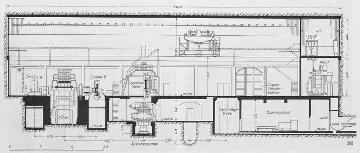
Bild 57. Zentrale Grimsel, Längsschnitt 1:300.
