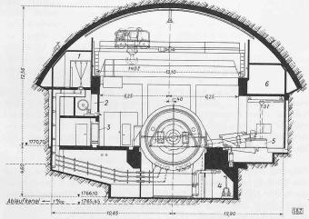
Bild 58. Zentrale Grimsel, Querschnitt 1:300. 1 13,5 kV-Raum, 2 Ventilationsgang, 3 Maschinen-Schalttafel, 4 Kühlergruppe für Generator, 5 Turbinenregler, 6 Garderobe, Aufenthaltsräume und Magazin,
