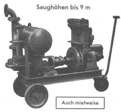
Leistungen 1—500 I/sek. Kein Bodenventil, Keine Klappe im Saugstutzen. Keine Hilfs-Vakuum-Pumpe. Jederzeitiges automatisches Ansaugen auch nach Lufteintritt im Saugrohr. Keine reibenden, sich abnützenden Dichtungsflächen, daher störungsfrei auch bei Schlamm-, Sand- und Kies-
