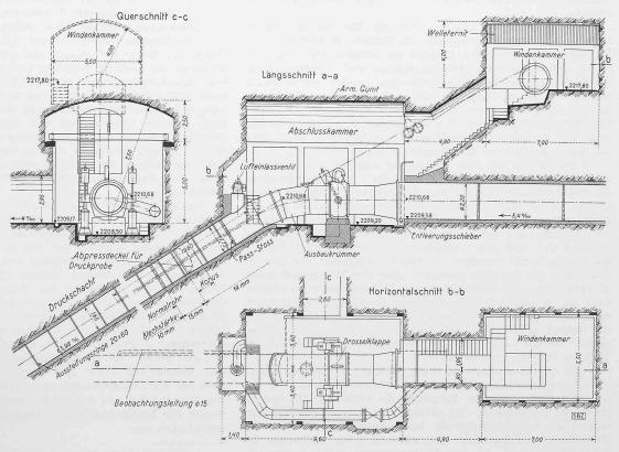
Bild 50. Abschlusskammer beim Wasserschloss, Masstab 1:250
