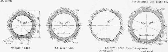
Bild 48. Querschnitte des Zulaufstollens, Masstab 1:100
