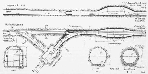
Bild 49. Zuleitung; Uebergang vom Zulaufstollen zum Druckschacht 1:600, Querschnitte 1:150
