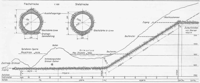
Bild 51. Druckschacht des Kraftwerks Oberaar, Längenprofil 1:10 000, Querschnitte 1:100
