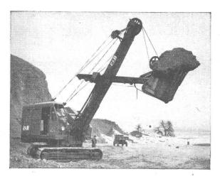
Löffelbagger mit Tru-Lay-Brugg-Drahtseilen ausgerüstet
