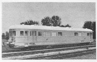
Bild 12. Diesel-elektrischer Gepäck-Triebwagen der Chemins de Fer Algériens, ausgerüstet mit zwei Sechszylinder-Sulzer-Dieselmotoren von ie 735 PS
