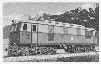
Bild 11. Dieselelektrische Lokomotive von 960 PS der Siamesischen Staatsbahnen
