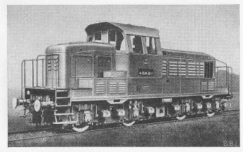
Bild 6. Sulzer-Diesel-elektrische Rangierlokomotive der Soc. Nationale des Chemins de Fer Français von 735 PS (Lieferjahr 1938)
