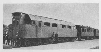
Bild 1. Erste Diesellokomotive der Welt, ausgerüstet mit einem Sulzer-Vierzylinder-Zweitaktmotor von 1000 PS, der die Triebräder direkt antreibt
