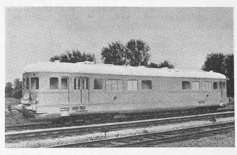
Bild 12. Diesel-elektrischer Gepäck-Triebwagen der Chemins de Fer Algériens, ausgerüstet mit zwei Sechszylinder-Sulzer-Dieselmotoren von je 735 PS
