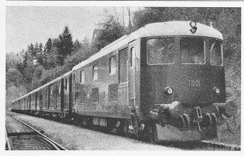
Bild 9, Diesel-elektrische Lokomotive der Schweizerischen Bundesbahnen von 1200 PS
