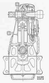
Rahmen bildet einen Bestandteil des Kurbelgehäuses. Aufmerksam- Bild 3. Querschnitt eines moderkeit widmeten Gebrüder Sulzer nen Sulzer-Einreihen-Traktions-Dieselmotors geschweisster Bauart
