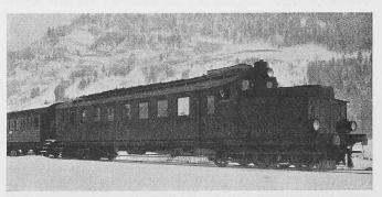
Bild 2. Einer der ersten Diesel-elektrischen Triebwagen der Welt, der im Jahre 1914 bei den Sächsischen Staatsbahnen in Betrieb gesetzt wurde.
