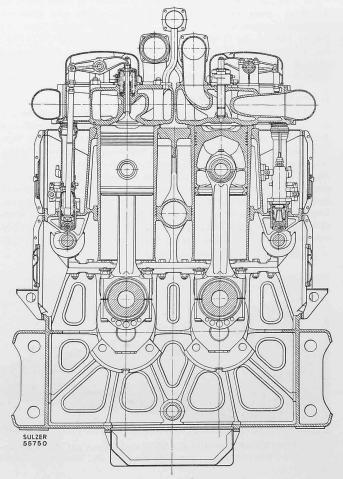
Bild 5. Querschnitt eines Zweireihen-Sulzer-Traktions-Dieselmotors geschweisster Bauart, Modell 1952
