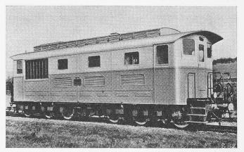
Bild 7, 735 PS Diesel-elektrische Güterzugslokomotive der Compagnie des Phosphates de Constantine
