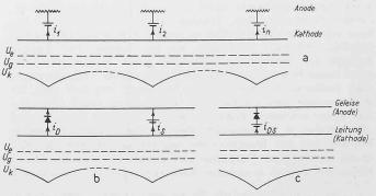
Bild 3. Ausführungen des kathodischen Schutzes. a. Der kathodische Schutz mit Sonderanoden; b. «Drainage» und «Soutirage» an verschiedenen Orten; c. «Drainage» und «Soutirage» an der selben Stelle.
