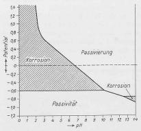
Bild 1. Korrosionsdiagramm für das System Eisen-Wasser (nach Pourbaix)
