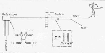
Bild 7. Hochspannungskabel Locarno - Ponte Ascona - Solduno. XX Stellen, an denen Erdschluss infolge Korrosion auftrat.
