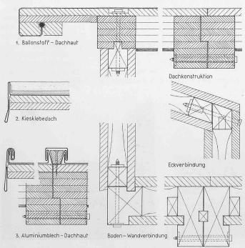
Bild 10. Verschiedene Dachausbildungen und konstr. Einzelheiten, 1:6
