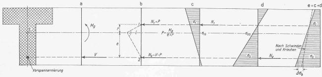
Bild 4. Spannungsverluste in vorgespanntem Balken
