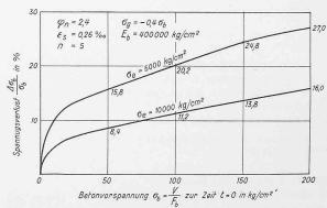
Bild 3. Beispiel für Spannungsverluste in zentrisch vorgespannter Säule
