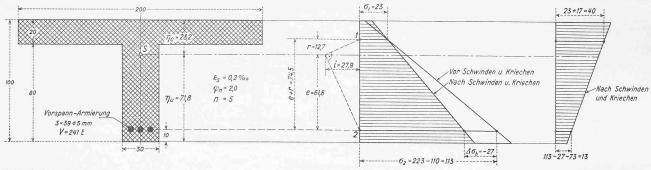
Bild 5. Beispiel für Spannungsverluste in vorgespanntem Balken
