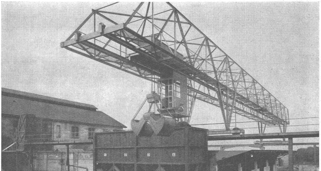
Verladebrücke in Schweisskonstruktion 2,5 t Tragkraft, 46 m Länge
