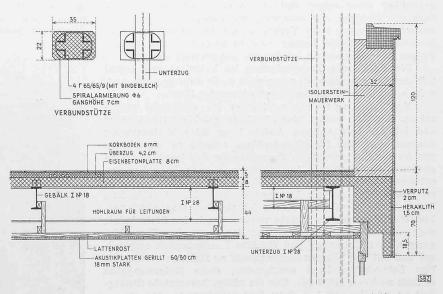
Bild 22. Laborgebäude; Ausbildung der Decken, Stützen und Fassaden, 1:30 Deckengewicht 335 kg/m²
