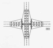
Bild 24. Versuchsgebäude, Knotenpunkt des Stahlskeletts, 1:30
