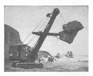
Löffelbagger mit Tru-Lay-Brugg-Drahtseilen ausgerüstet
