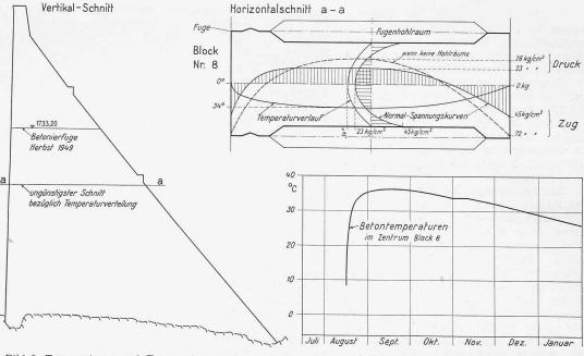
Bild 9. Temperaturen und Temperaturspannungen in der Staumauer Rätherichsboden
