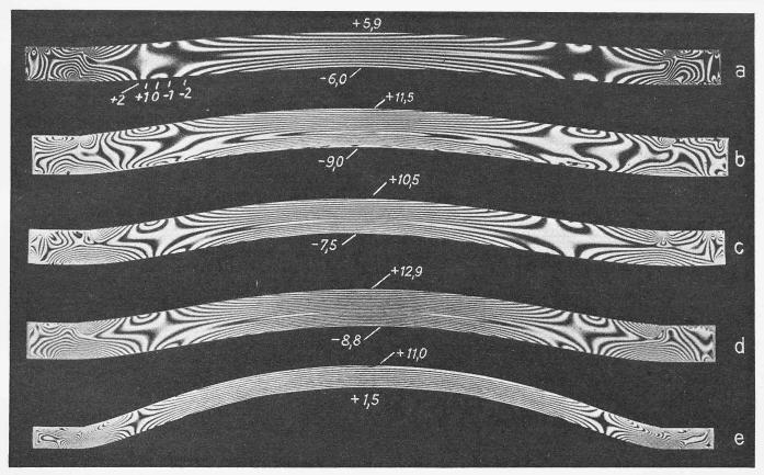
Bild 18. Symmetrieschnitte aus den Platten 1 bis 5
