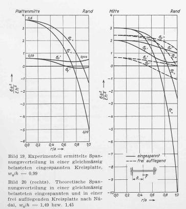
Verlauf von  $\sigma_{t'}$ in einer frei aufgelagerten Platte zeigt (Bild 20, gestrichelte Kurve).
