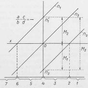
Bild 4. Graphische Darstellung der Drehzahlen und der Drehmomente eines Umlaufradgetriebes ohne Reibung mit negativer Uebersetzung
