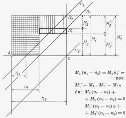
Bild 8. Graphische Darstellung der Leistungen eines Umlaufradgetriebes mit Reibung für ein positives Uebersetzungsverhältnis und einem Antrieb des Systems I bezogen auf den Steg, während gegen aussen System I als Abtrieb wirkt
