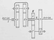
Umlaufradgetriebe ent-Sprechend Stelle A von Bild 5 erreicht durch zwangsläufige Verbindung der Systeme II und III  $n_2 = \frac{e}{f} \, \frac{g}{h} \, n_3$
