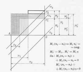
Bild 9. Graphische Darstellung der Leistungen eines Umlaufradgetriebes mit Reibung für ein positives Uebersetzungsverhältnis und einem Abtrieb des Systems I bezogen auf den Steg, während System I gegen aussen als Antrieb wirkt
