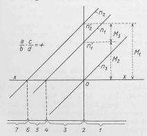
Bild 3, Graphische Darstellung der Drehzahlen und der Drehmomente eines Umlaufradgetriebes ohne Reibung mit positiver Uebersetzung
