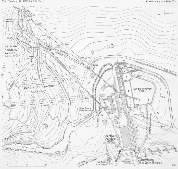
Bild 31. Ausgleichbecken und Wasserfassung Handeck, Plan 1:2500. 1 Sandfang, 2 Spülschieber, 3 Beruhigungswand, 4 Regulierschütze Schwelle 1300,69, 5 Vorbecken, 6 Einlauf, 7 Freier Ueberfall, 8 Saugüberfall, 9 Einlauf mit Feinrechen, 10 Entleerung, 11 Pumpschacht, 12 Abschluss Drosselklappe Stollenzugang, 13 Abschluss Segmentschütze
