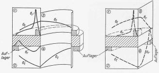
Bild 13a. Spannungsverlauf bei Platte 1
