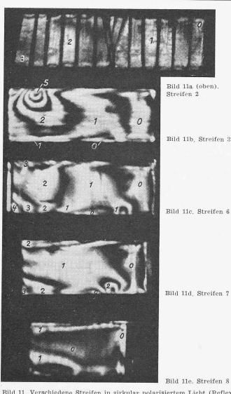
Bild 11, Verschiedene Streifen in zirkular polarisiertem Licht (Reflex-aufnahmen)
