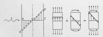
Bild 1. Lineare Verteilung der Biegespannungen nach dem Gradliniengesetz
