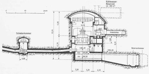
Bild 28. Zentrale Handeck II, Querschnitt C-C 1:600
